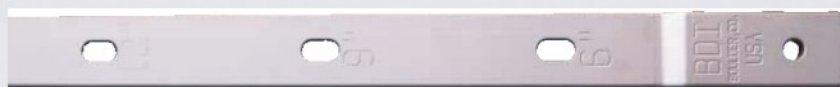
适用于钢筋混凝土构件“平均应变值”检测的传感器延长装置
